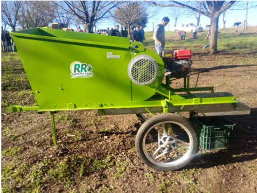
**Figura 2.** Equipamento de pré-limpeza das nozes diretamente no pomar.
