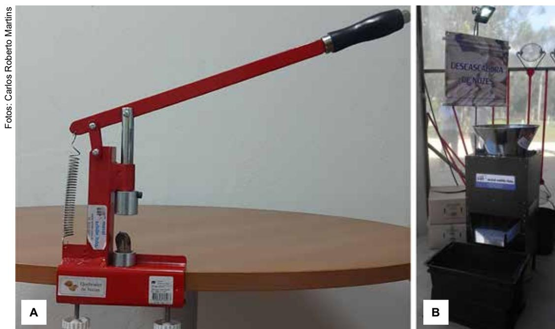
**Figura 13.** Quebrador e descascadora de noz-pecã: quebrador manual (A) e descascador automático (B).
