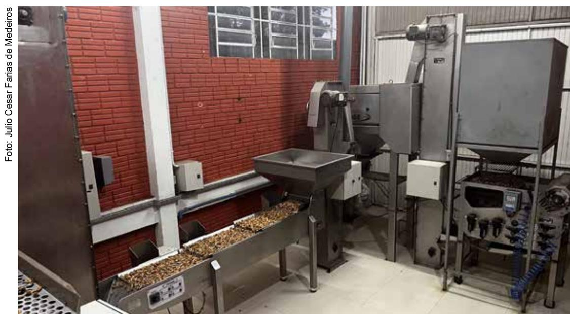
**Figura 14.** Descascadora e classificadora pneumática com esteira para processamento de noz-pecã.
