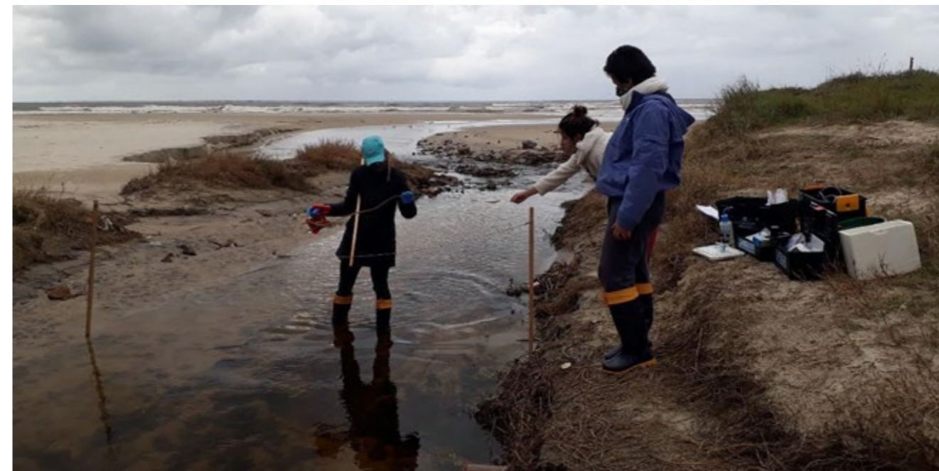
Medição da seção transversal do sangradouro para cálculo da área molhada e posterior determinação da vazão.
