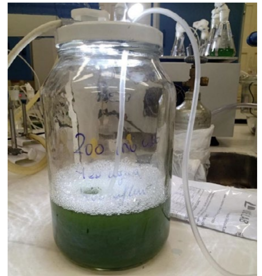
Biorreator de 3 litros com aeração montado para experimentos de produção de microalgas utilizando efluentes como meio de cultivo.
